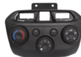
Comando Ar Condicionado
