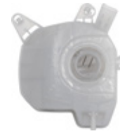
Reservatório Água Radiador
